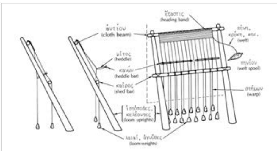
**Ил. 1.** Схема вертикального ткацкого станка: ἄντιον — катушка ткани (*cloth beam*), μίτος — галево (*heddle*), κανών — ремиза (*heddle bar*), καΐρος — нитеразделительный пруток (*shed bar*), ιστόποδες κελέοντες — опорные балки ткацкого станка (*loom uprights*), λαιά, ἀγνῦθες — пряслица (*loom-weights*), έξαστις — кромка готовой ткани (*heading band*), πήνη, χρόκη — нить утка (*weft*), πτυνίον — челнок (*weft spool*), στήμων — нить основы (*warp*) [Barber 1992: 270]
